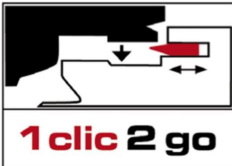
Este innovador sistema de fijación sin cola permite evitar que la tensión provocada por las dilataciones y contracciones naturales del suelo afecte al machihembrado.
